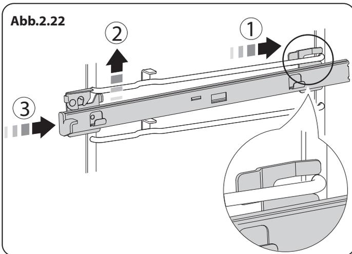
vordere Schnapper hebt und senkt sich, um die Schiene zu sichern (Abb.2.24).
